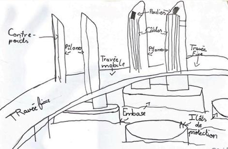
Schéma Pont Chaban-Delmas réalisé par une élève (Olivia)
