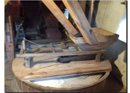
La trémie vibre pour permette aux grains de blé d'être bien répartis sur la meule.
