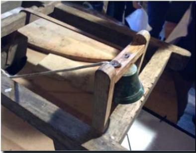
Un système de cloche permet au meunier d'être alerté si il n'y a plus de blé. Cela évite la chauffe des meules qui pourrait mettre le feu.
