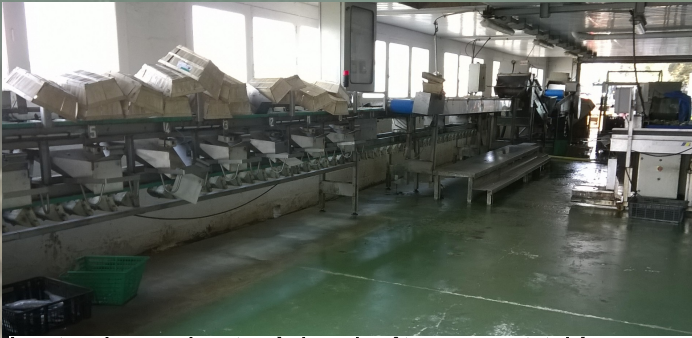
Le tapis roulant où les huîtres sont triées
